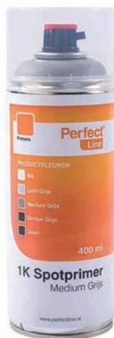
Primaire monocomposant à séchage rapide. Peut être utilisé sur des supports traités et non traités en acier, aluminium et acier galvanisé. Convient comme prétraitement pour la finition avec des peintures acryliques à un ou deux composants, des peintures à base de résine alkyde et des peintures à base d'eau. Ce produit a une teneur élevée en solides, un fort pouvoir couvrant et garnissant, une bonne protection contre la corrosion, une grande efficacité, un séchage rapide, ponçable facilement.
